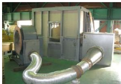
図1 加圧給気室実験設備
