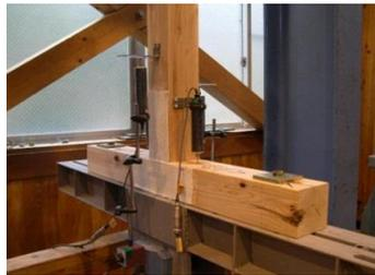
写真2 柱脚接合部試験
