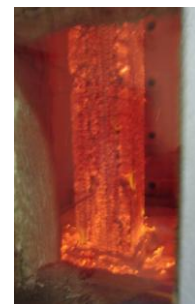
図 燃え止まり確認 (第三者試験合格)
