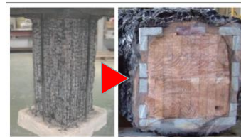
耐火性能1時間の集成材 耐火試験後の断面 図 初期の開発実験結果
