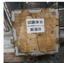
図 燃え止まり確認 (第三者試験合格)
