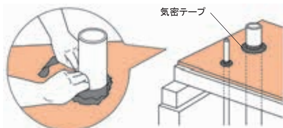
図 5.9.4 床の配管まわりの気密
