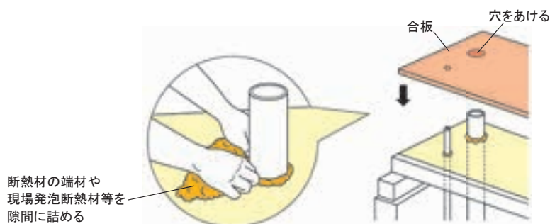
図 5.9.3 充填断熱工法の床の断熱補強
