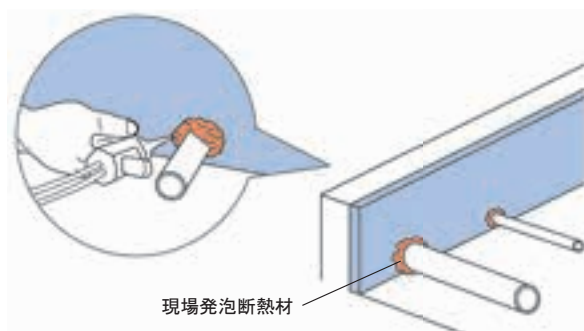
図 5.9.6 基礎断熱の断熱補強
