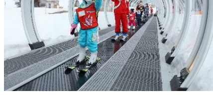
スノーエスカレーターの導入により、初心者・キッズ向けコースの利便性を向上
