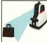
自律走行する警備ロボットにて巡回。巡回中の画像をオペレーターと共有するとともに、放置物検知の場合は、金属探知機を搭載したアームでの点検も実施する。
