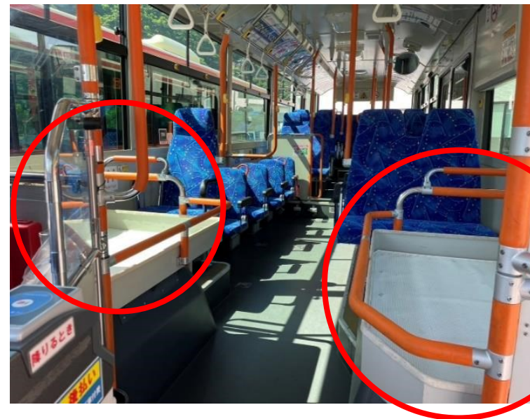
ラゲージスペース整備後
