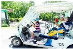
天窓カート ゴルフカートを活用したパークモビリティ。2012年運行開始。 約3km/hの速度で標高差200m以上の1500mを約30分かけてのぼる。 自動運行のため運転免許は必要ないが、あらかじめ研修が必要となる。 後部に車いすを載せることが可能。 料金：1200円/人、4名/人/2024年
