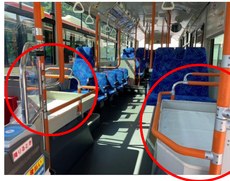
ラゲージスペース整備後
