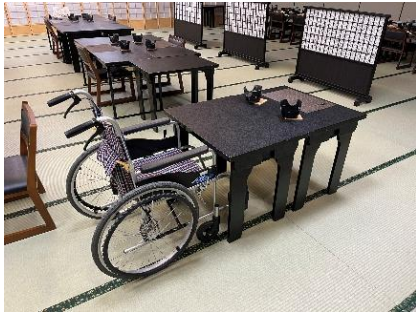
■ 車いすの手すりが取まらないテーブルの高さ
