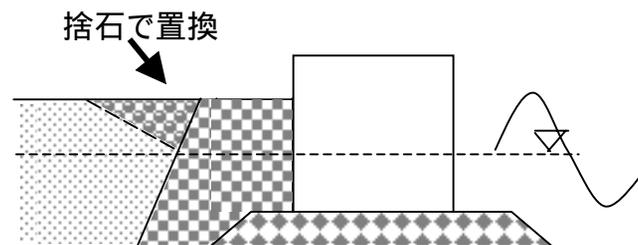
図5 天端置換捨石による陥没孔防止対策
