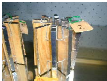
写真2 シール後のデシケーター用試料
