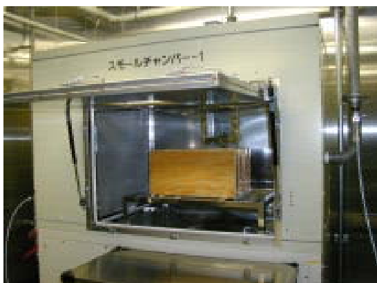
写真3 チャンバーへの試料の設置状況
