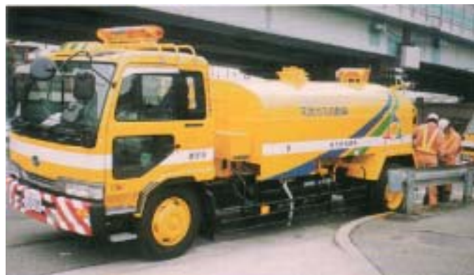
道路の清掃に活躍する天然ガス(CNG)車 [排水管清掃車]
