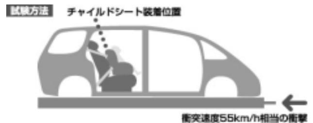
なお、衝突速度は、国の安全基準（道路運送車両の保安基準）で実施される適合性確認のための試験と比較して1割増しの時速55kmで実施します。
