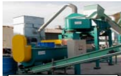
FRPとレタン分別（分別機） FRPと再生油混合（混合機）
