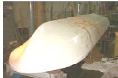
船底部（キール、隔壁は2次接合）
