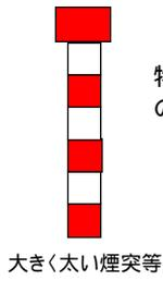
物件の幅が高さの10分の1以下の場合、昼間障害標識を設置
