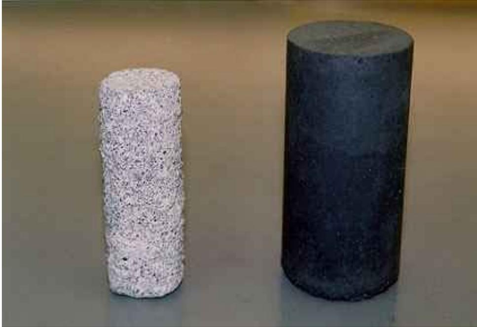
耐硫酸モルタル(10%硫酸溶液に4週間浸漬したモルタルの外観)
