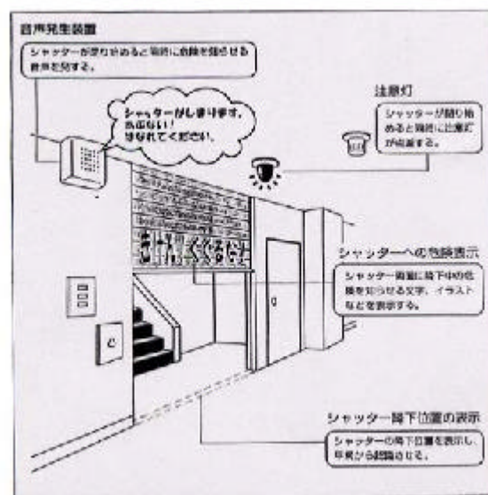
図 3-1-1 防火シャッターの注意喚起装置
