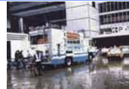
排水ポンプ車 (福岡市)
