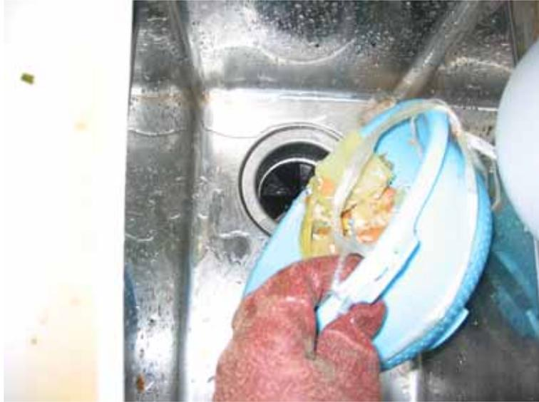
写真 3.2.2 厨芥の水質転換率調査の状況（厨芥の投入状況）<sup>8)</sup>
