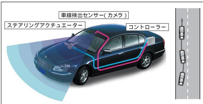
カメラで前方の車線を認識し、高速道路の直線路で車線を維持するようにハンドル操作を支援します。
