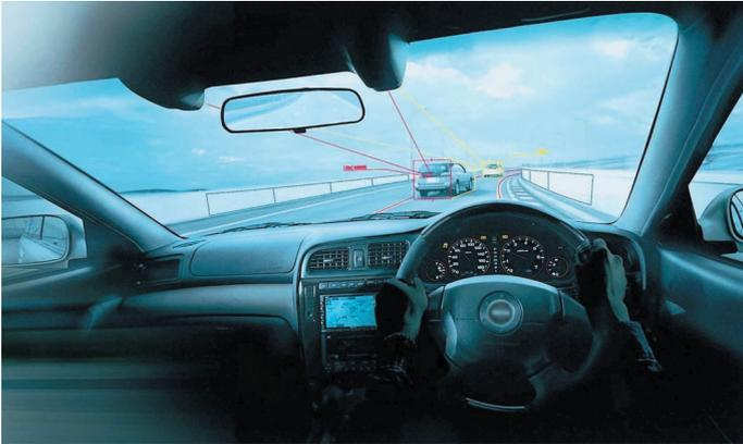
カーブに進入する速度が大きく危険と判断される場合、運転者に音声で注意を促し、状況に応じてシフトダウン制御を行います。
