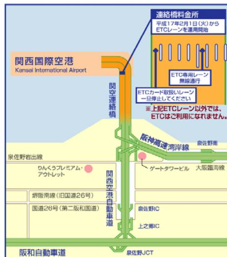
○進行方向右側から3番目のレーンに無線通行できるETC専用レーンを配置する。
