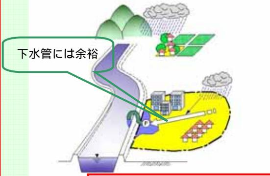
下水道の雨水排水能力以下の降雨であるが、河川へ放流できないことによる浸水
