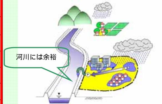
下水道の雨水排水能力を上回る降雨による浸水
