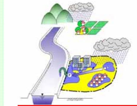
下水道の雨水排水能力を上回る降雨による浸水と、河川へ放流できないことによる浸水
