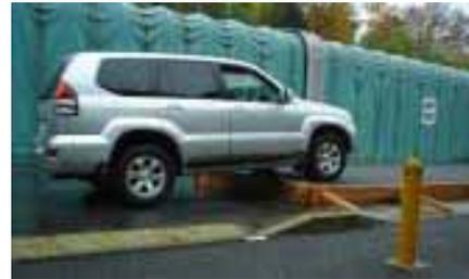
図-1 段差走行試験の状況（段差25cm）
