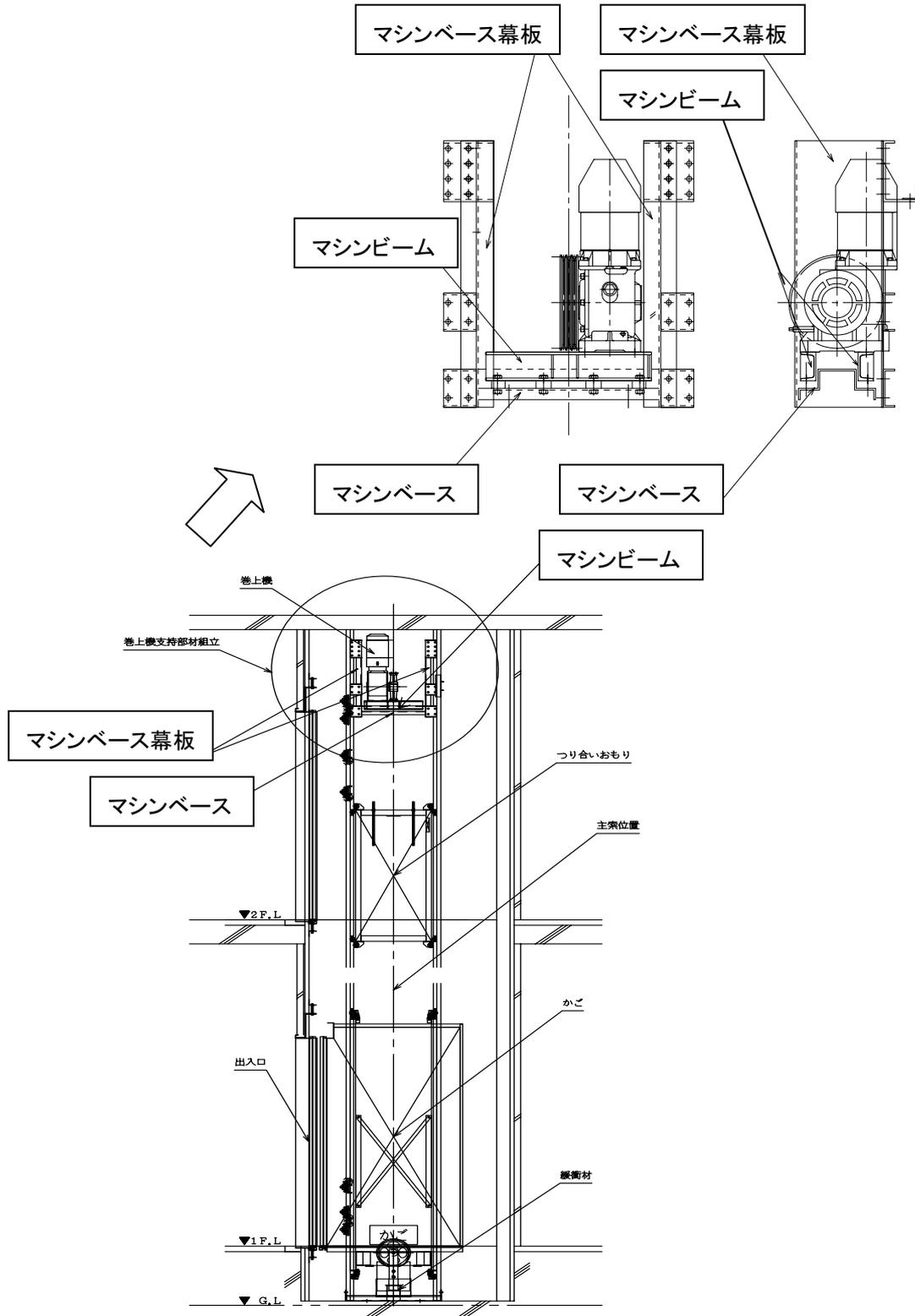
※ [ ] 強度の低い鋼材が一部の構造材に使用された部位
