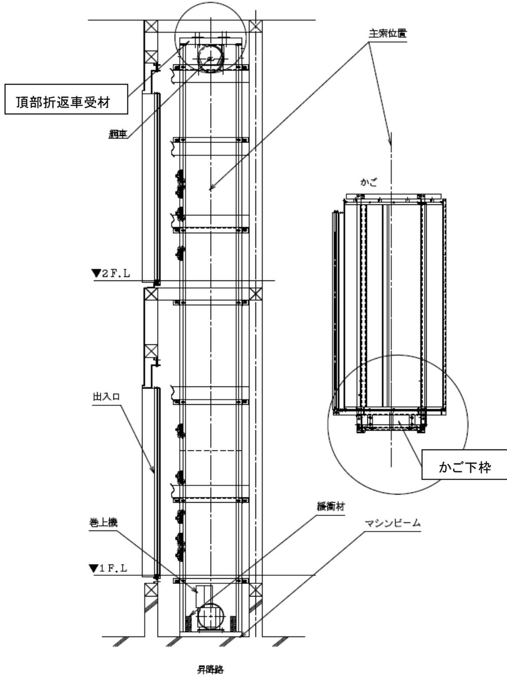
※  強度の低い鋼材が一部の構造材に使用された部位
