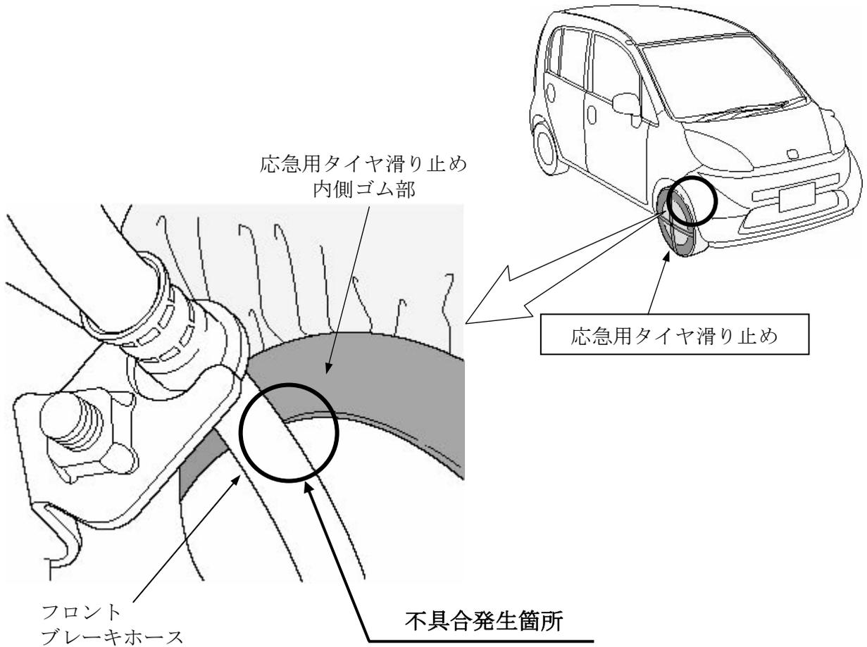
後付け部品の軽自動車専用の応急用タイヤ滑り止めにおいて、装着寸法が不適切なため、ライフとゼストに新品を装着すると内側のゴム部が前輪のブレーキホースと接触するものがある。そのため、その状態で走行を続けるとブレーキホースに損傷をあたえるおそれがある。
