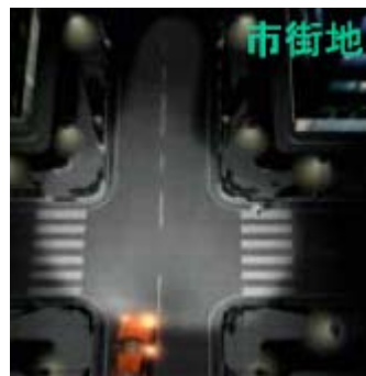
照度を落とすことにより街灯下の人や物の視認性を向上
