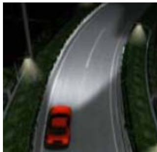
かじ取装置の操舵角等に応じて配光を進行方向に屈曲
