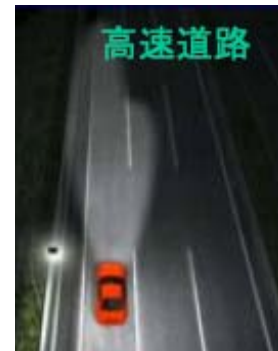
高速で走行する間、障害物の視認性を高めるため遠方の道路を照射
