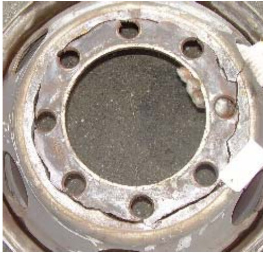
A：円周状の亀裂（破断）
