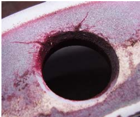
B：ホイールボルト穴の座面の亀裂
