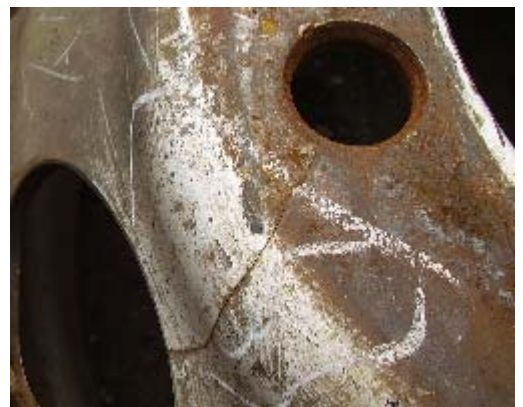
C：飾り穴の亀裂
