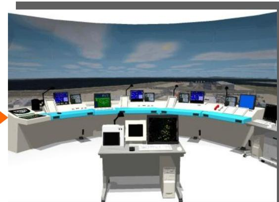
導入される飛行場管制用バーチャルシミュレーター
