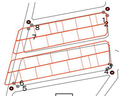
現況測量結果図と公図の重ね合わせ図
