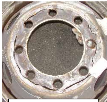
円周状の亀裂（破断）
