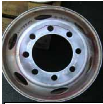
円周状の亀裂（亀裂のみ）
