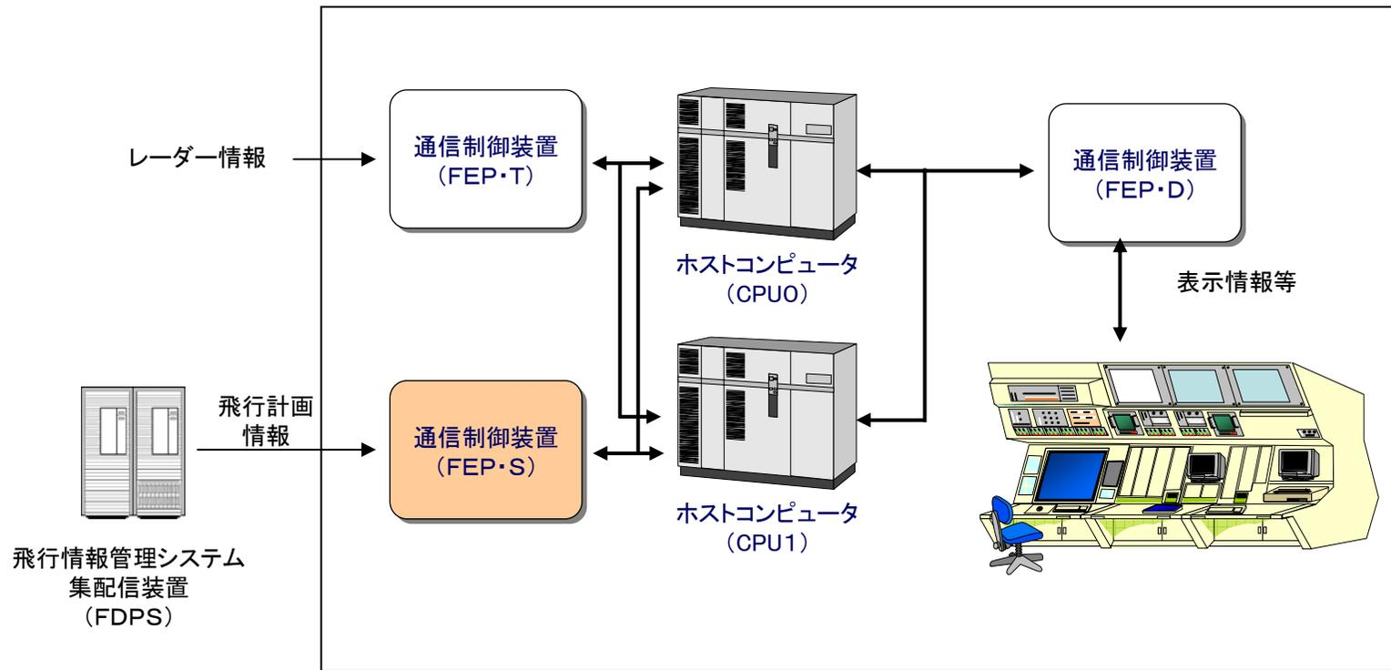
航空路レーダー情報処理システム(RDP)構成概略図
