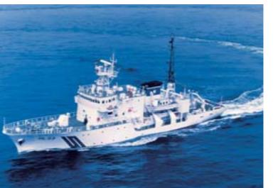
観測を行う測量船「明洋」と、マストに設置されているGPSアンテナ。
