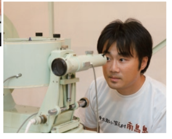
(写真上) 比較較正室で磁気儀を使った観測の様子。コイルの軸が地磁気の方角を向くよう調整する。 (写真下) また機器の向いている方角を正確に知るために、真北の指標となる「方位標」の角度を望遠鏡で読み取る。
