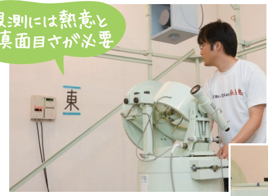
(写真上) 比較較正室で磁気儀を使った観測の様子。コイルの軸が地磁気の方角を向くよう調整する。 (写真下) また機器の向いている方角を正確に知るために、真北の指標となる「方位標」の角度を望遠鏡で読み取る。
