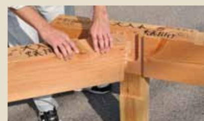
上段／車庫の屋根を支える柱・梁には、強度の高い岡山県産の欧洲赤松を使用。右／木材に取り付けた車庫シャッター用の金属製レール。下段／接合部の正確さを確認するため、事前に製作した原寸サンプル。
