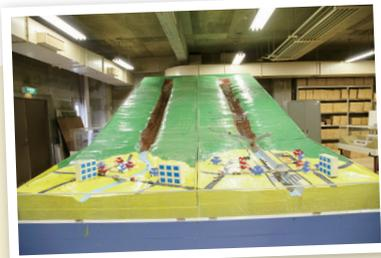
「現場力」でも紹介した、土石流をシミュレーションできるジオラマも人気施設の一つ。水と土砂が川を流れてくる土石流は迫力満点。その仕組みを知るとともに、被害を防ぐための対策についても学べます。
