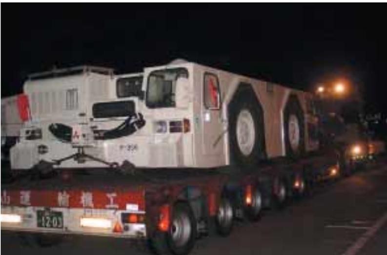
トレーラーに積載された航空機牽引車の陸送状況
