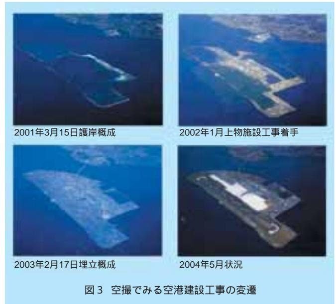
図3 空撮でみる空港建設工事の変遷
