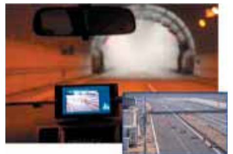
トンネル出口の車線規制情報提供
