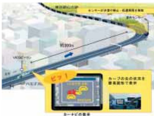
図3 前方障害物衝突防止支援システム
