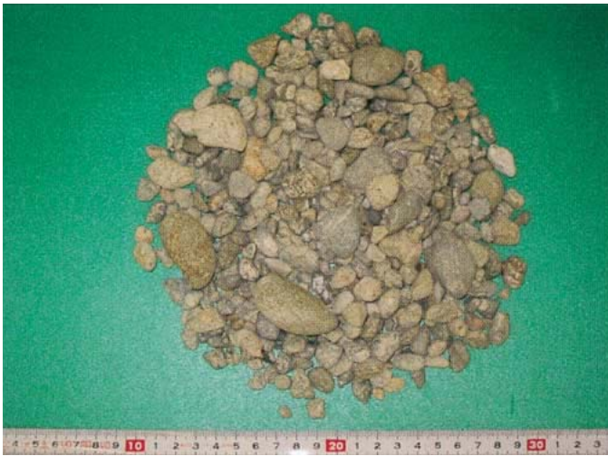
中品質再生粗骨材の例(スクリー摩砕式)
