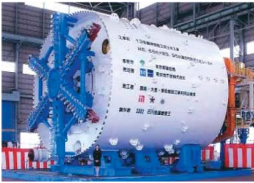
写真1 泥土圧シールド機（複線）
