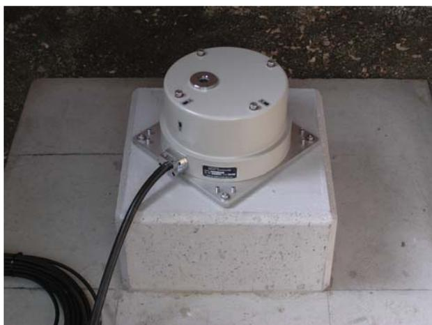
写真-2 岩国港に設置された速度型強震計のセンサー（広島港湾空港技術調査事務所提供）
