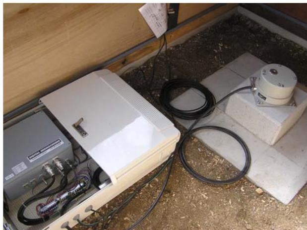
写真-1 岩国港に設置された速度型強震計とコンクリート製の基礎（広島港湾空港技術調査事務所提供）
