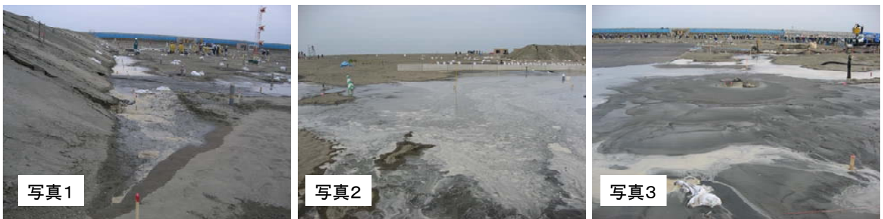
図-8 発破後における液状化の様子
