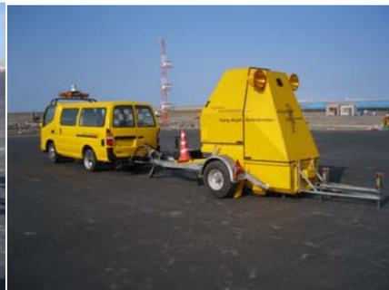
写真-2 空港舗装対応 FWD 装置
