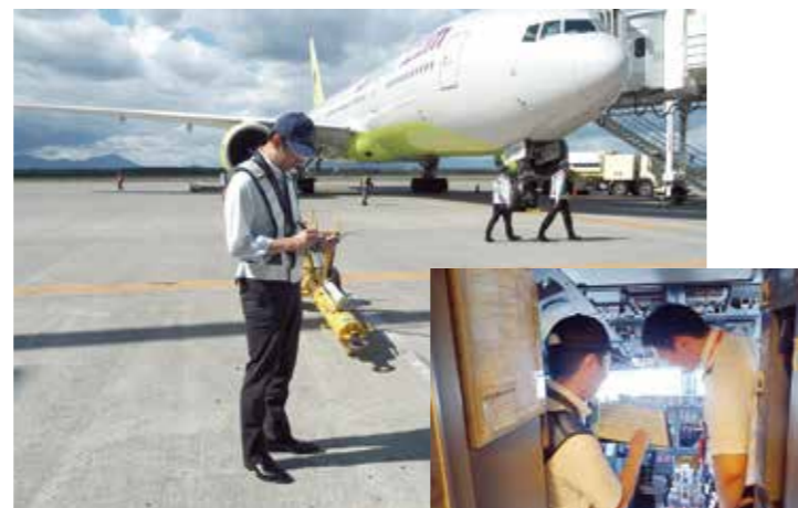
ランブインスペクション 駐機中の外国航空機への立入検査
