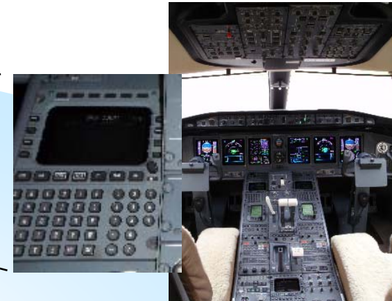
データリンク端末を装備した操縦室 (例)
