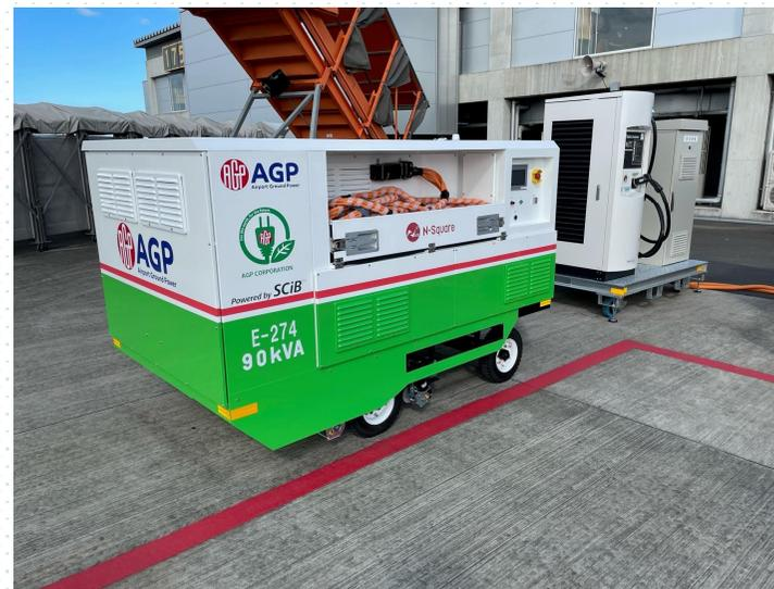
バッテリー駆動式GPU 寸法 L2,745×W1,480×H1,620mm 重量 2,200kg以下
