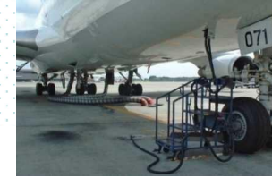
電力供給の様子
