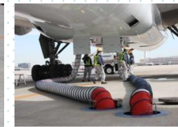
エアコン供給の様子
