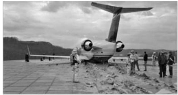
写真 - 2 アレスティングシステムによる拘束事例
