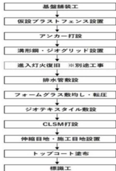
図-6 アレスティングシステム施工フロー
