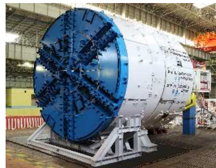
写真 - 2 シールドマシン
