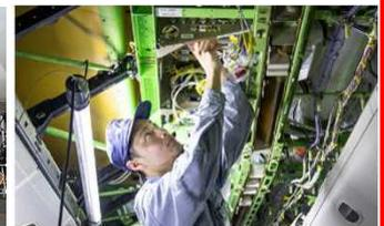
航空機整備作業の例(主脚の交換、電子装備品の交換・調整)
